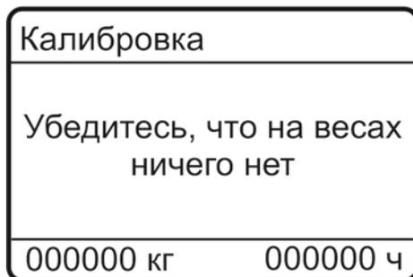
11.2.2.4. Установите на весы калибровочный груз весом 10 кг, нажмите «ПУСК».
