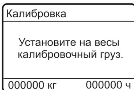
11.2.2.5. После звукового сигнала калибровка завершена.
