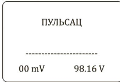
В тесте пульсаций прибор отображает пульсации напряжения в режиме реального времени и показывает напряжение пульсаций и напряжение зарядки в нижней строке.
