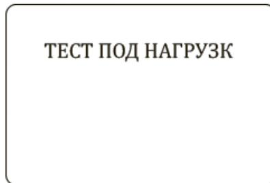
Тест напряжения под нагрузкой длится примерно 3 секунды, затем появляется сообщение «УВ ОБНАР» (Нажать педаль акселератора для увеличения частоты вращения вала двигателя):
