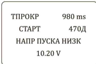
Это позволяет техническому персоналу быстро определить состояние системы стартерного пуска. После завершения тестирования, не выключая двигатель, нажать кнопку ОК, чтобы войти в режим тестирования системы зарядки.
