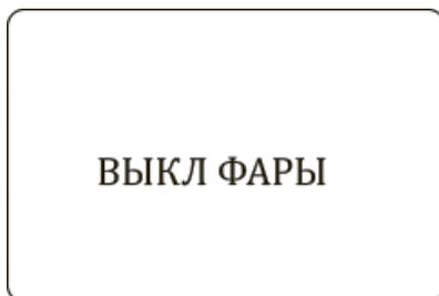
Теперь тестер определяет отсутствие поверхностного заряда, необходимо выключить фары и нажать кнопку ОК. Тестер повторно производит контроль АКБ.
