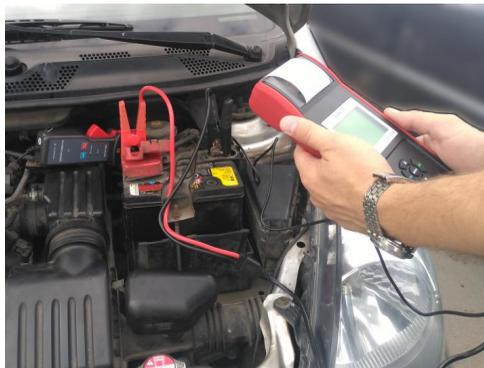
Максимальный диаметр провода, который смогут охватить токовые клещи, не более 27,5 мм, провода большего диаметра охватить не получится.
