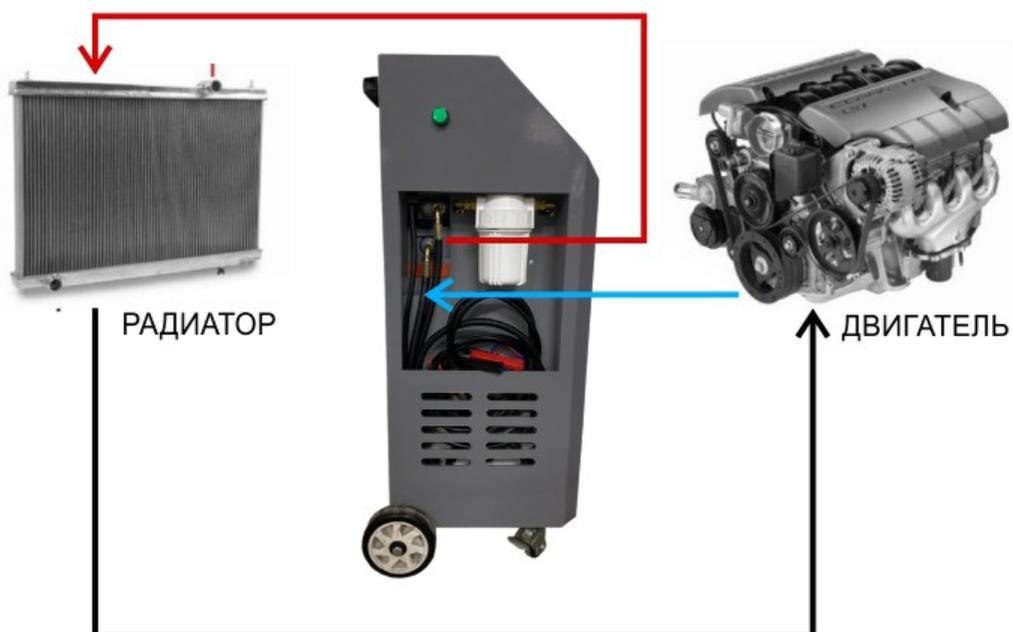
Рис. 3 Схема подключения изделия к системе охлаждения автомобиля
