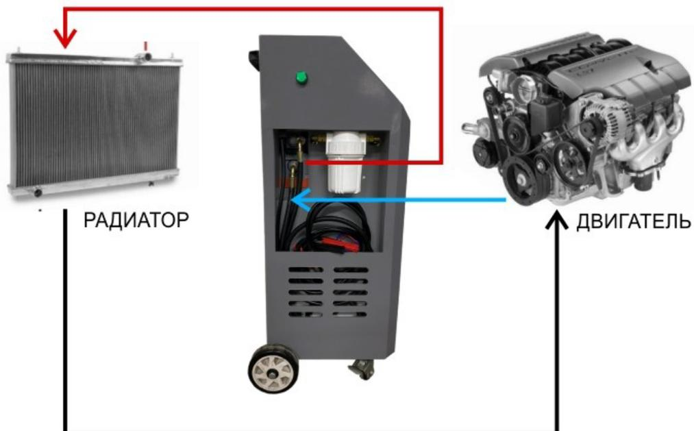
Рис. 3 Схема подключения изделия к системе охлаждения автомобиля
