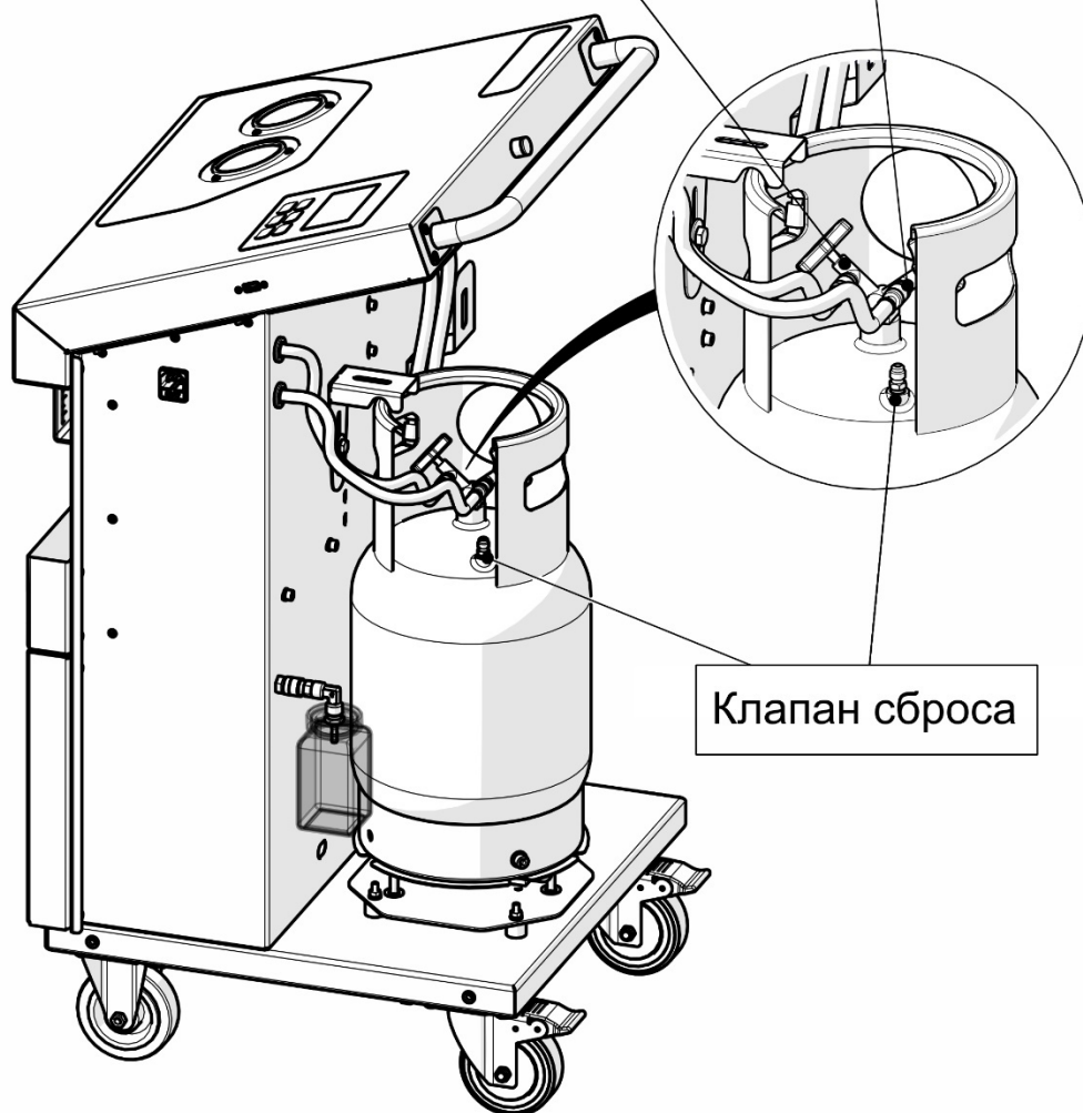
Рис. 7 Сброс неконденсируемых газов.
