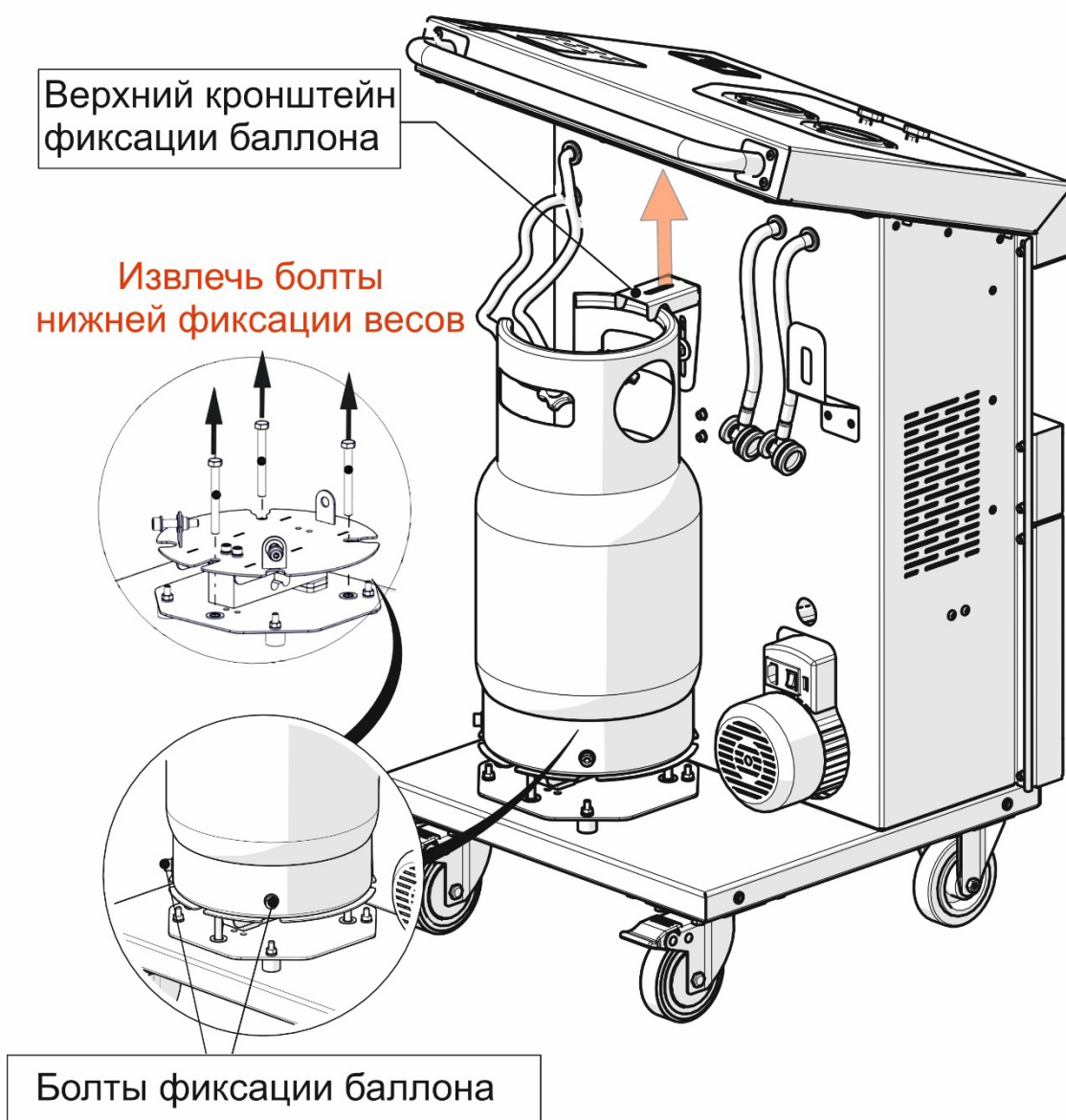
Рис. 5 Фиксация внутреннего бака
