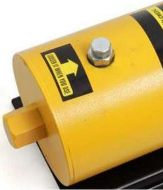
Для предотвращения утечек масла во время транспортировки устанавливается и затягивается металлическая ручка. Ослабьте ее, повернув против часовой стрелки перед использованием.
