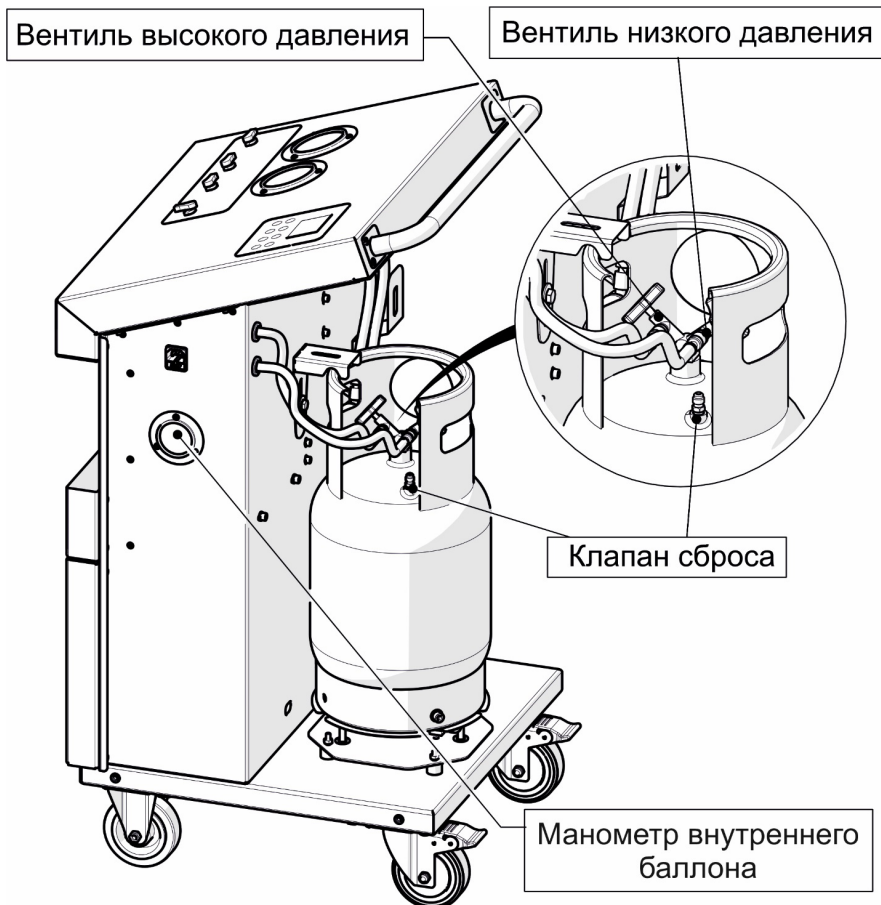
Рис. 7 Сброс неконденсируемых газов.
