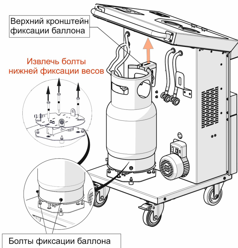
Рис. 5 Фиксация внутреннего баллона
