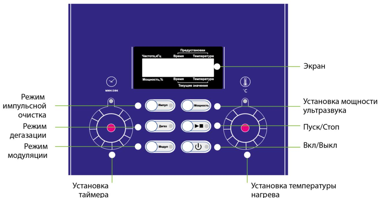
**Обратите внимание:** объем ванны, указанный в "Наименовании" заводом изготовителем, рассчитывается по формуле  $D \times W \times H$ , где  $D$  (длина) и  $W$  (ширина) измеряются по верхней внутренней границе бака,  $H$  (глубина) - максимальное расстояние от верхней кромки бака до его дна. Реальный объем ванны в литрах отличается от заявленного, т.к. конструкция бака конусообразная. При выборе ультразвуковой ванны ориентируйтесь на ее рабочий объем.
