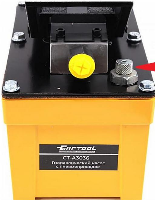
Для предотвращения утечек масла во время транспортировки устанавливается и затягивается металлическая ручка. Ослабьте ее, повернув против часовой стрелки перед использованием.
