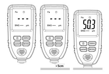
«CON»: Режим непрерывного измерения. Нажмите на кнопку «MODE», на экране появится «CON», установите вертикально датчик данные будут постоянно обновповерхность, ляться по мере движения датчика, как показано (Примечание: **ZERO** кнопка продолжительном измерении используется для калибровки. Пожалуйста, используйте ее только в целях калибровки. Для более информации, пожалуйста, детальной прочитайте нижепривед енную главу калибровке).
