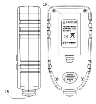
15.V-образный паз для измерения изогнутых поверхностей
