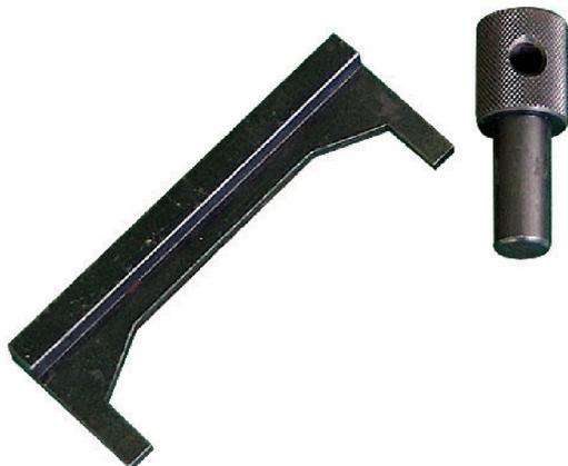
Комплект приспособлений предназначен для установки фаз ГРМ дизельных двигателей, например VW Transporter с 1990 по 2003 год выпуска с монолитным зубчатым колесом ТНВД.
