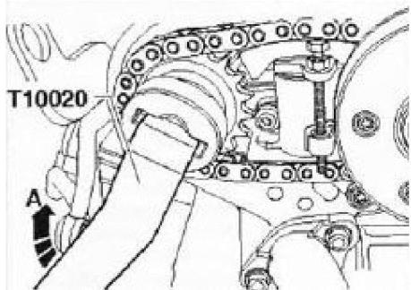
Установку регулятора необходимо выполнять с помощью специального ключа T10020. При этом необходимо перед установкой регулятора сжать натяжитель короткой цепи с помощью фиксатора T10115. После установки необходимо возвратить его в первоначальное положение.
