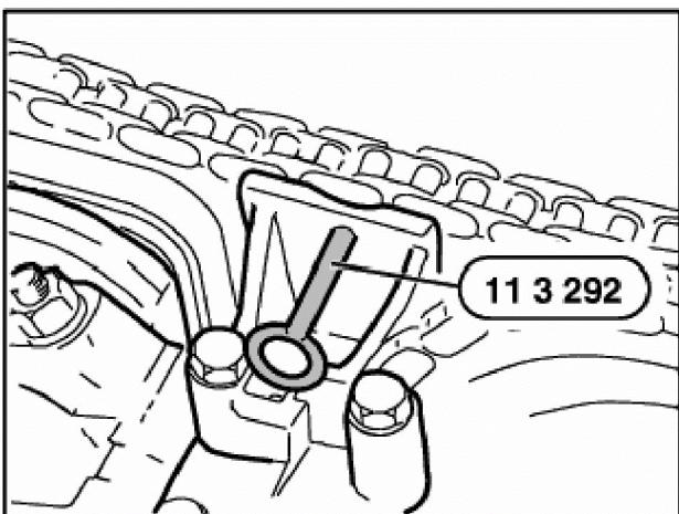
При регулировке фаз ГРМ есть необходимость ослабить верхний натяжитель (нажатием его вниз) с помощью фиксатора 113 292
