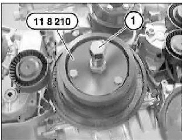
На рис. 1 изображен болт, с помощью которого происходит снятие (упор в торец коленчатого вала).
